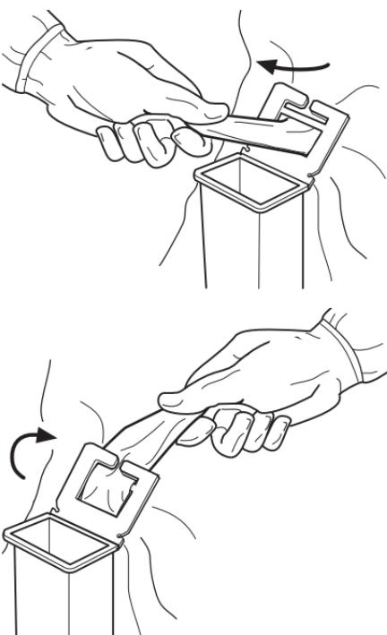
3. Rimuovere il protettore della punta dall'elettrodo. Inserire l'elettrodo del manipolo nella presa dell'*interruttore manuale* di un generatore Covidien.
